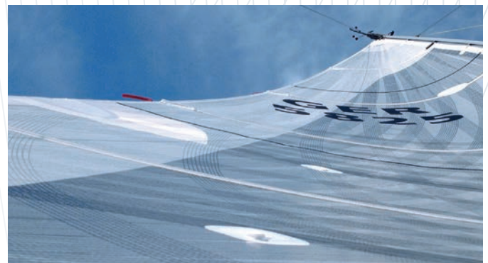
Ein X-DRIVE® CARBON Großsegel mit einer Taffeta-Beschichtung im Achterliek.
