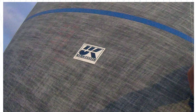
Nahaufnahme einer LiteSkin® Beschichtung (Anthrazit) auf einer Genua.
