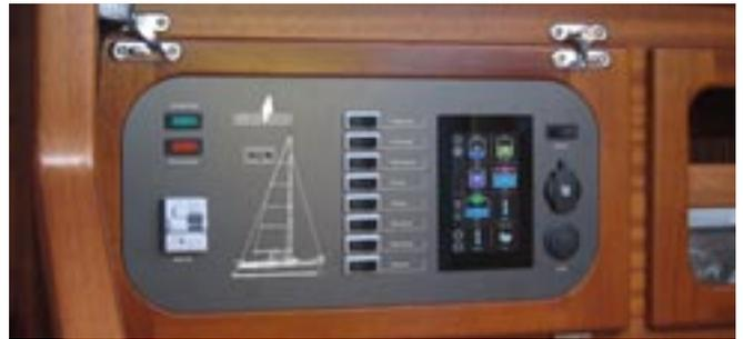
Um die vorhandene elektrische Anlage von Bavaria Segel-Yachten zu modernisieren, bieten wir für das ab Werk verbaute Panel 301 ein Austauschpanel an. Das Austauschpanel ist mit einem Kabelbaum vorkonfektioniert, um eine einfache und sichere Montage zu ermöglichen. Über das mitgelieferte Tankinterface TIL können die ab Werk verbauten Bündelensonden der Wassertanks an den Batterie-Tank-Monitor BTM angeschlossen werden.
