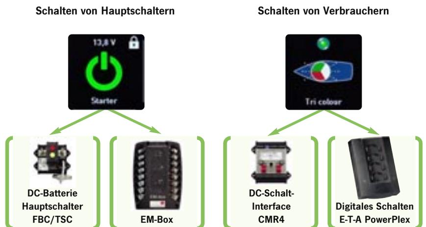
Der System Monitor PSL informiert auf seinem 5" Farb-Touchscreen auf drei verschiedenen Seiten über alle zur Verfügung stehenden Daten der elektrischen Anlage. Auf der Informationsanzeige werden die Batterie-, Tank-, Temperatur- und Bilgeninformationen dargestellt. Die Energie-Seite informiert über den Status der DC und AC Anlage. Auf der Steuerungsseite können die Hauptschalter und die Verbraucher geschaltet werden.
