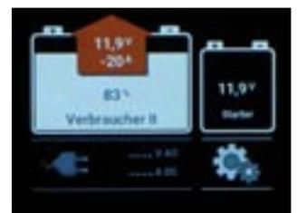
Das in den Automatlader integrierte Interface ACE-LIN ermöglicht dem Batterie-Monitor BLS die Überwachung und Steuerung des Ladevorganges des Automatladers ACE zur Optimierung der Ladung.
