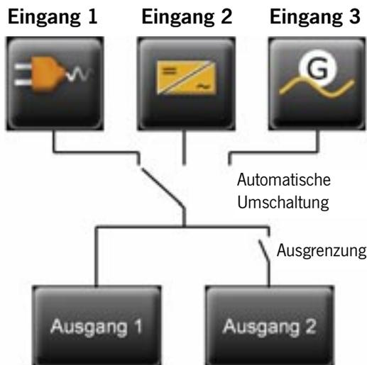
Die Umschalteinheiten LAU werden als reine Umschalteinheit zur Nachrüstung in bestehende Anlagen oder mit integriertem RCBO-(FI/LS) Schutzschalter und auf Wunsch mit Raum für die Integration zusätzlicher Komponenten wie Interface CAV (Seite 43) oder Leitungsschutzschalter MCB angeboten. Die Landanschlusseinheiten können auf Ihre Anforderungen in Bezug auf Anzahl und Leistung der Energiequellen und Verbraucher angepasst werden.
