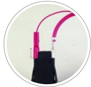
Der Anschluss erfolgt über Flachsteckhülsen 6,3 mm auf der Rückseite der Geräte.
