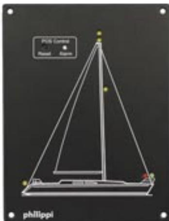
Die elektronische Positionsleuchten-Überwachung erkennt den Ausfall der Glühlampe oder der Leuchtdioden (LED) bzw. eine Kabelunterbrechung. Bei Funktion der Positionsleuchten zeigen die zugeordneten Leuchtdioden auf dem Display die Funktion an. Sobald der Ausfall einer Laterne über die Elektronik gemeldet wird, blinkt auf dem Display die betreffende Leuchtdiode und zusätzlich ertönt ein akustisches Signal, das über eine Taste quittiert werden kann.
