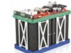
Die Epsilon Lithium-Batterie zum direkten Austausch gegen eine Standard 90 Ah Blei-Batterie in 12V -Systemen, zur Kapazitätserhöhung können bis zu 3 Batterien parallel geschaltet werden. Integriertes Lade- und Entlademanagement. Keine externen Komponenten erforderlich!
