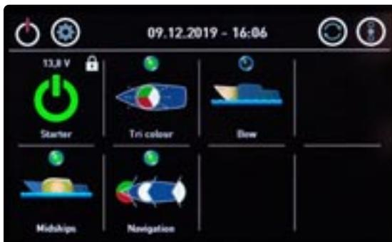
Auf der Schaltseite werden die Schaltfunktionen dargestellt. Dabei können sowohl die Batterie Hauptschalter bedient werden als auch der Schaltzustand der Automatikfunktionen des Universal-Relaismoduls CMR4 abgelesen und darüber hinaus auch manuell gesteuert werden. Ferner stehen auch Schaltfunktionen zum Schalten und Dimmen von LED-Leuchten und anderen Verbrauchern zur Verfügung, auch in Verbindung/als Bedieneinheit für das ETA Powerplex System.
