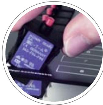
Die thermischen Sicherungsautomaten können nachträglich ohne großen Aufwand gegen einen anderen Sicherungswert (4, 6, 8, 10, 12 oder 16 A) ausgetauscht werden.
