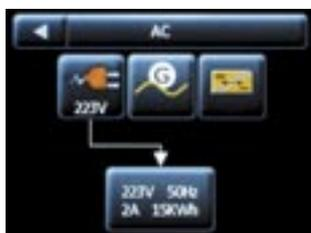
Bei Einbau eines AC-Interface CAV werden zusätzlich zur Spannung auch die Leistungsdaten der AC-Anlage erfasst und angezeigt
