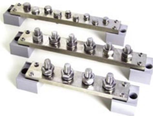
Hochwertige Minuspol-Sammelschienen speziell für große Querschnitte. Geeignet zur Verteilung von Batteriezuleitungen und Kabelabgängen für Ankerwinden, Bugstrahlruder und weiteren Verbrauchern. Der Nennquerschnitt der Schiene beträgt 300 mm<sup>2</sup>. Galvanisch vernickelte Kupferschiene auf Kunststoff-Isolierstützen montiert
