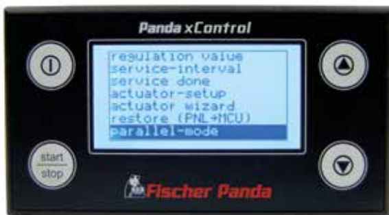
Parallelmodus mit jedem Generator der xControl-Serie möglich
